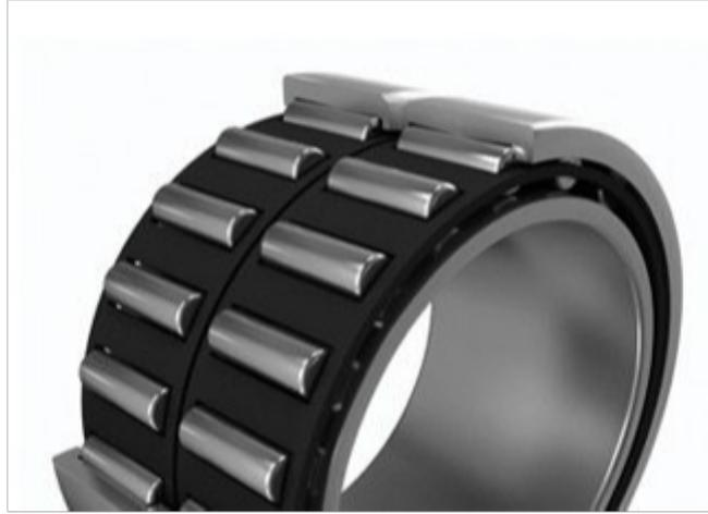
日常维护四，在润滑轴承时，油脂涂的越多越好吗？润滑轴承时，油脂涂的越多越好，这是一个常见的错误概念。轴承和轴承室内过多的油脂将造成油脂的过度搅拌，从而产生极高的温度。轴承充填润滑剂的数量以充满轴承内部空间 $1/2 \sim 1/3$ 为宜，高速时应减少到 $1/3$ 。五，如何安装和拆卸？安装时勿直接锤击轴承端面和非受力面，应以压块、套筒或其它安装工具（工装）使轴承均匀受力，切勿通过滚动体传动力安装。如果安装表面涂上润滑油，将使安装更顺利。如配合过盈较大，应把轴承放入矿物油内加热至 $80 \sim 90^{\circ}\text{C}$ 后尽快安装，严格控制油温不超过 $100^{\circ}\text{C}$ ，以防止回火效应硬度降低和影响尺寸恢复。在拆卸遇到困难时，建议您使用拆卸工具向外拉的同时向内圈上小心的浇洒热油，热量会使轴承内圈膨胀，从而使其较易脱落。上海沃安精密轴承有限公司为您提供轴承，有需要可以联系我司哦！[洛阳精密轴承资质](#)
